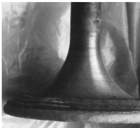
Рис. 7. Наплавленный клапан двигателя тепловоза
