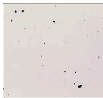
Рис. 5. Неметаллические включения в наплавленном металле (× 400): а – при плазменно-порошковой наплавке постоянным током прямой полярности; б – при плазменно-порошковой наплавке разнополярно-импульсным током
