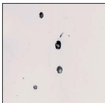
Рис. 5. Неметаллические включения в наплавленном металле (× 400): а – при плазменно-порошковой наплавке постоянным током прямой полярности; б – при плазменно-порошковой наплавке разнополярно-импульсным током
